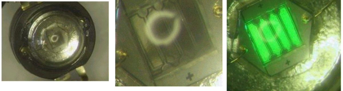
Figuur III-4 doorsnede en microscoopfoto van een Luxeon.
